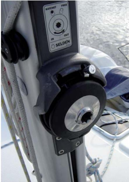
Bei Bedienung der Rollgroßanlage stets die Stellung des Arretierhebels beachten!
